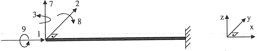
Şekil 3. Konsol bir elemana uygulanan birim kuvvet yönleri
