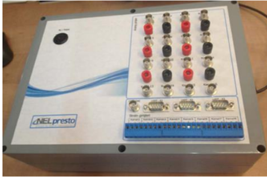
Şekil 2. CUSHAKE sarsma tablası veri toplama sistemi [15]
