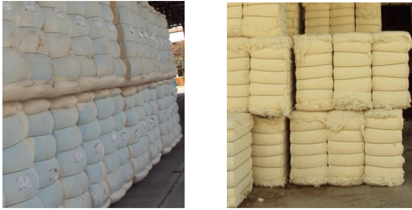
Şekil 5. Sawgin ve rollergin çırçır makinesinde çırçırlandı, preselenmiş balyalar
