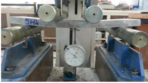
Şekil 5. Eğilme deneyi test cihazı
