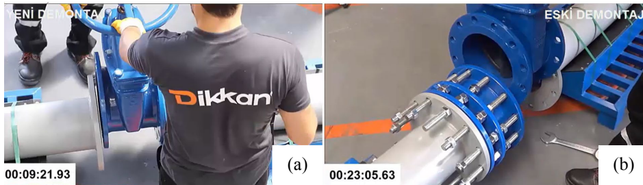
Şekil 19. Yeni tasarım demontaj parçası (a) ile geleneksel demontaj parçasının (b) operasyon sürelerine ait karşılaştırma çalışması
