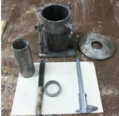
Şekil 4. Konsolidasyon deney numunelerini hazırlamak için kullanılan malzemeler
