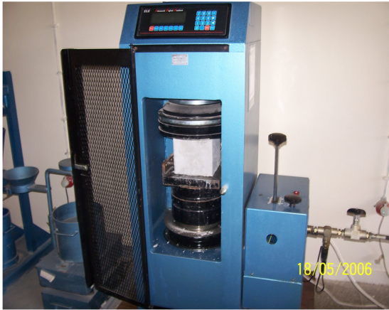
Şekil 16. Hazırlanan beton örneklerinin dayanım deneyleri
