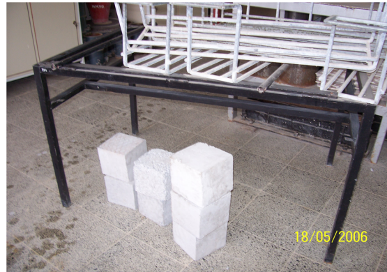
Şekil 15. Küp şeklinde hazırlanmış beton örnekleri
