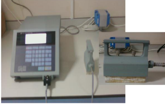
Şekil 13. Isı iletkenlik katsayısı tayini deneyi
